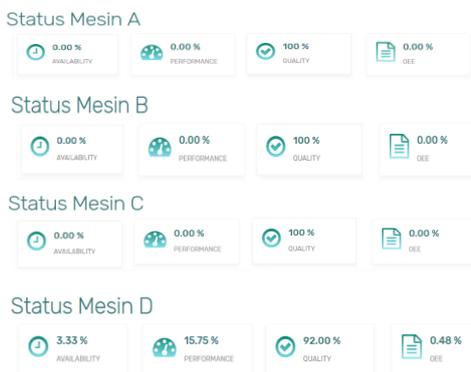
Gambar 15 Hasil Perhitungan Otomatis Nilai Efisiensi Mesin
